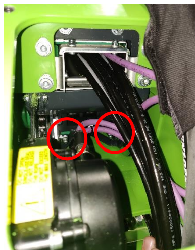
Obrázok 19. Body mazania kladky reťaze teleskopického výložníka na konci pri spoji dolného a horného výložníka
