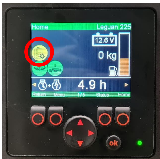
Obrázok 31. Diagnostický symbol chyby na „Domovskej stránke“
