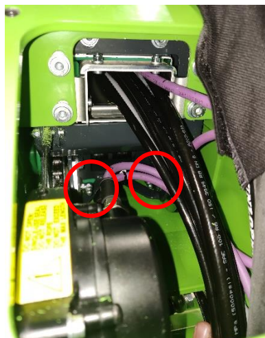
Afbeelding 19. Smeerpunten poeliewiel telescoopketting bij het onderste en bovenste arm-verbingsstuk
