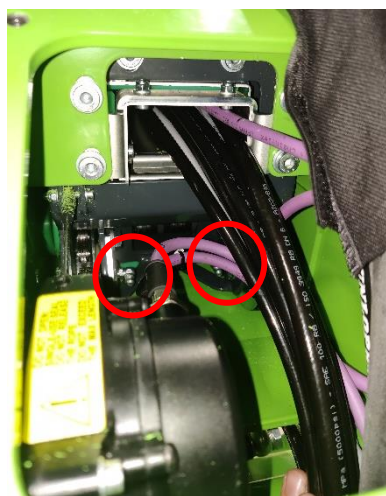
Figur 19. Smøringspunkter på taljehjul på teleskopkæden ved den nederste og øverste ende af bomforbindelsesstykket
