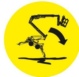
Wenn der Neigungsalarm während der Fahrfunktionen aktiviert wird, fahren Sie die Maschine auf eine ebenere Fläche.
