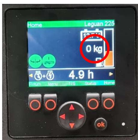
Abbildung 41. Last der Arbeitsplattform auf dem Display
