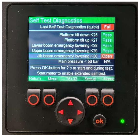
Abbildung 36. Fehler auf der Seite „Selbsttest-Diagnose“
