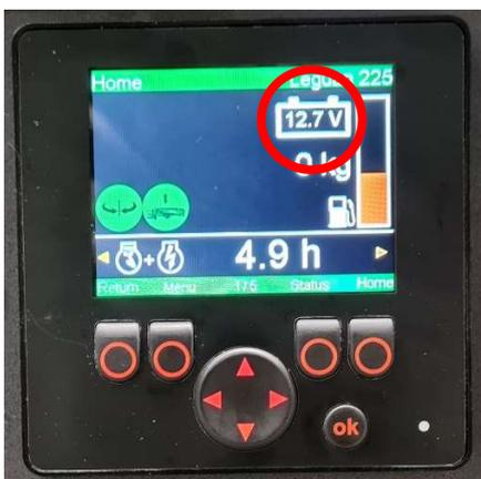
Abbildung 48. Batteriespannung auf dem Display
