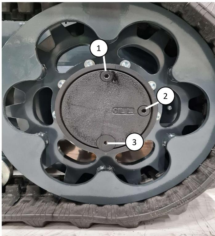
Abbildung 29. Getriebeölwechsel beim Antriebsmotor
