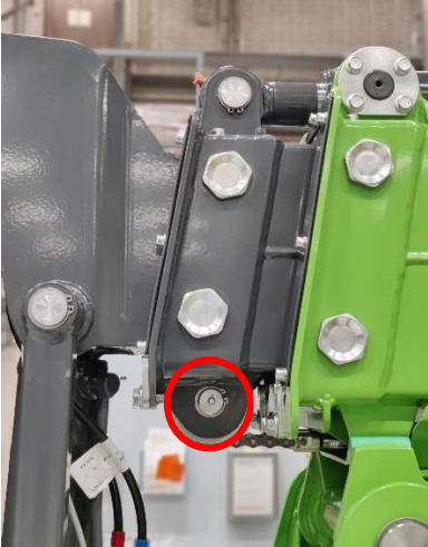
Kuva 22. Käyttöketjun voitelupiste 2. jatkeen työtason puoleisessa päässä
