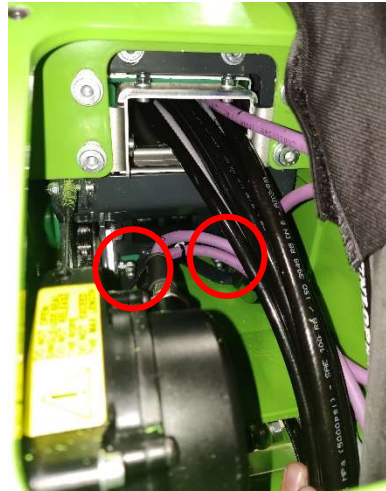
Kuva 23. Käyttöketjun voitelupisteet taittopuomin päätykappaleen puoleisessa päässä
